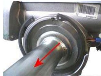
4) Richten Sie die Referenzmarken sorgfältig aus, indem Sie die Welle nach Bedarf drehen. Entfernen Sie den Sensor, indem Sie mit einem Schraubendreher oder einem ähnlichen Werkzeug auf den unteren Teil einwirken.
