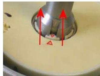
5) Gehen Sie umsichtig bei der Montage des neuen Sensor vor: Der Clip muss perfekt orthogonal zur Kunststoffstruktur sein, damit beide Sensor-"Scheiben" solide zusammengehalten werden.
