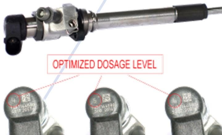
Die rot eingekreisten Zahlen geben die Klasse der optimalen Kraftstoffdosierung an. Unterschiedliche Werte können zu Dekompensation und Unregelmäßigkeiten im Motorbetrieb und bei der Verwaltung der Abgase führen.
